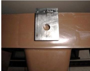
2. Une fois les 2 palettes percées de 4 trous chacune, poser les palettes retournées sur le sol, en prenant soin de mettre les 2 faces percées l'une contre l'autre. Positionner les semelles fines de largeur 80 mm sur les pieds en extrémité et la semelle épaisse de largeur 150 mm sur les pieds au centre. Emboîter à force.
